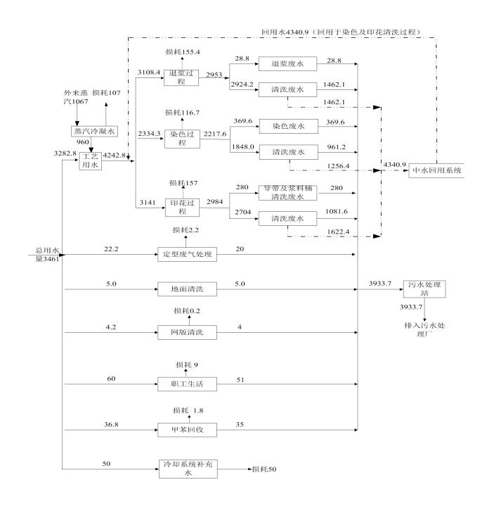
图 3.2-9 项目水平衡图 (以天计 t/d)
