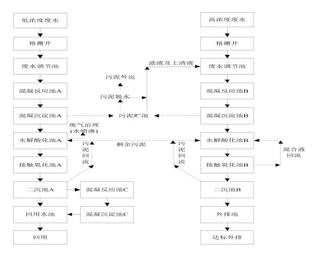
图 3.1-7 废水处理工艺流程图
