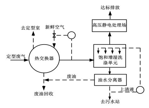
图 3.1-10 竣工验收阶段定型废气处理工艺流程
