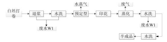
图 3.1-10 前处理及印花工艺流程及产污环节示意图
