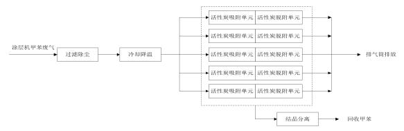
图 6.2-2 涂层废气处理工艺流程图
