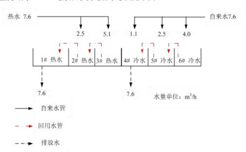
图 3.2-5 退浆后水洗过程示意图(1~3#槽内为 80℃的热水,其余均为自来水)
