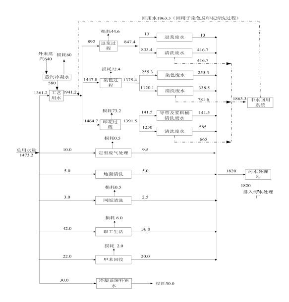
图 3.1-6 华联印染现有项目水平衡图
