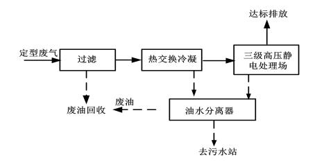
图 3.1-11 改造后定型废气处理工艺
