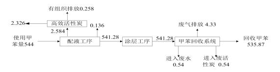
图 3.2-7 甲苯平衡图 (单位: t/a)
