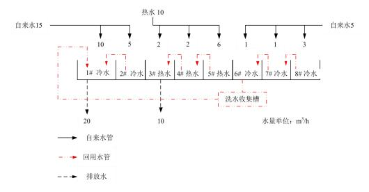
图 3.2-6 印花后水洗过程示意图(3~5#槽内为 80℃的热水,其余均为自来水)
