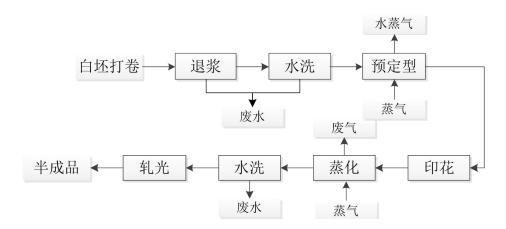
图 3.1-2 普通印花工艺流程及产污环节示意图
