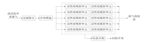
图 3.1-9 甲苯废气治理工艺流程图
