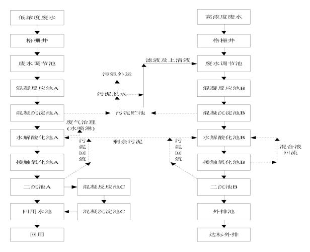
图 6.2-3 项目印染废水处理工艺流程图
