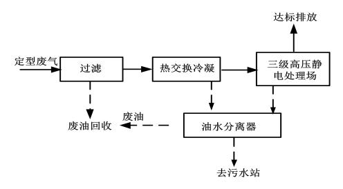
图 6.2-1 定型废气处理工艺流程图
