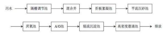
图 4.3-1 二期工程污水处理工艺流程图
