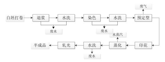
图 3.2-2 印花生产工艺流程图
