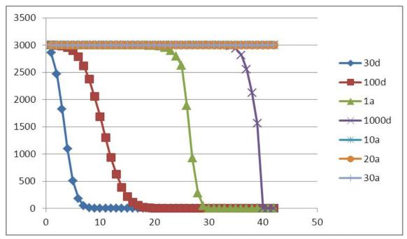
图 5.2-1 CODer 地下水运移情况示意图(横坐标单位 m, 纵坐标单位 mg/L)
